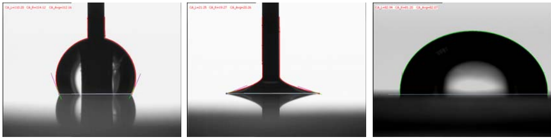
图 1 分析方法：曲线尺拟合法（圆拟合、spline 拟合、广义二次曲线拟合等）。
